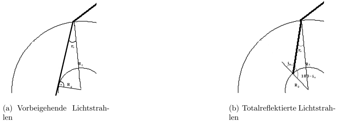
Abbildung 25: Geometrie der Strahlengänge in einem Rohr
